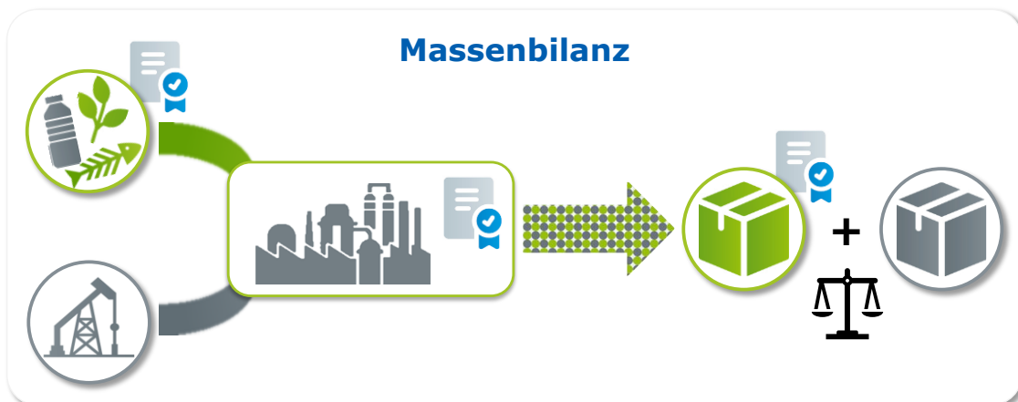
Abbildung 5: Schematische Darstellung einer Massenbilanz. Eingehende Materialien werden nicht physisch voneinander getrennt, sondern können gemeinsam gelagert und verarbeitet werden. Die Zuordnung von Nachhaltigkeitseigenschaften erfolgt bilanziell durch ein Kontoführungssystem innerhalb des Massenbilanzzeitraums.
