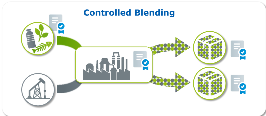
Abbildung 4: Schematische Darstellung eines Controlled-Blending-Prozesses. Eingehende nachhaltige und konventionelle Materialien werden in einem bekannten Mischverhältnis gemeinsam verarbeitet, wodurch alle Produkte den gleichen physischen Anteil nachhaltiger Materialien beinhalten.
