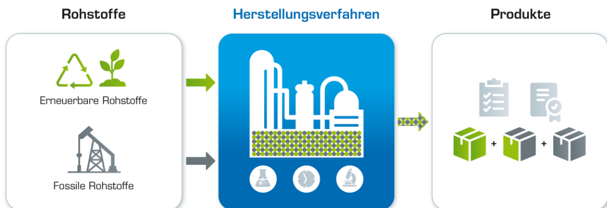
Abbildung 1: Schematische Darstellung des Massenbilanzansatzes. Die Zuordnung (Attribution) nachhaltiger Eigenschaften erfolgt unter Berücksichtigung sämtlicher Konversionsraten.
